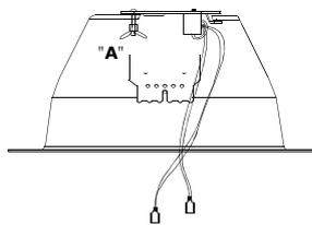
1) Retirez l'écrou "A" situé à l'intérieur du capot anti-feu.
