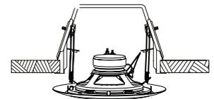
1) Montagebügel in Deckenausschnitt einsetzen.
