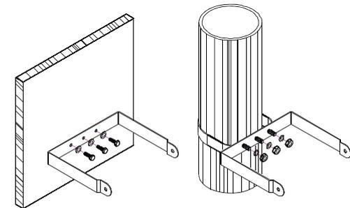
**1)** Retirez l'étrier en forme de "U" du haut-parleur. Alignez le sur le support et marquez les points de fixation. Fixez le sur le support à l'aide de fixations appropriées (non fournies).
