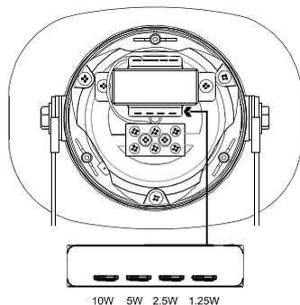
**3)** Lors de la sélection de puissance souhaitée, le câble d'installation peut être monté via un presse-étoupe présentant un calibrage adapté pour une entrée de 20 mm de diamètre.
