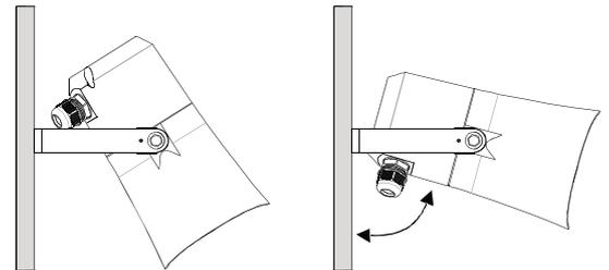
**5)** Remplacez l'enceinte sur le support en forme de "U". Positionnez le haut-parleur à l'angle désiré, puis serrez les fixations.
